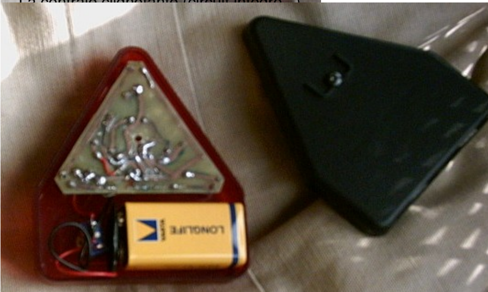
Le controle clignotante (circuit intégré )
