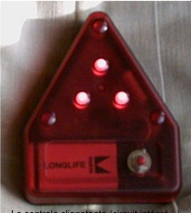
Le controle clignotante (circuit intégré )
